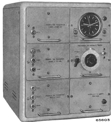
Fig. 2 Horloge à quartz Précision garantie 10^{-7}
