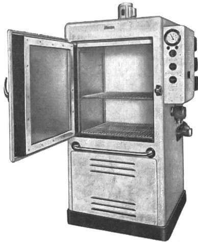
Fig. 4 «Therma»-Prüfschrank mit Temperatur- und Feuchtigkeitsregelung
