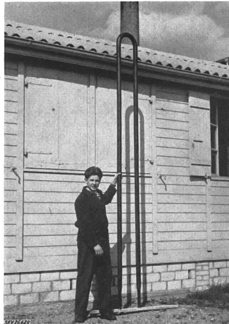
Fig. 7 U-förmige Rundkupferschiene 20 kV mit Duresca-AH-Isolation Beide Enden sind kapazitiv gesteuert, der übrige Teil ist mit Erdbelag versehen
