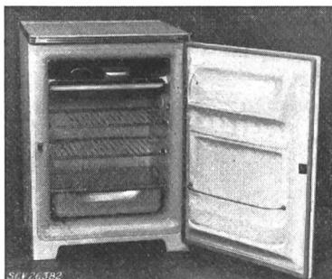
à incandescence avec contact de porte. Extérieur en tôle laquée, intérieur émaillé. Amenée de courant à trois conducteurs, fixée au réfrigérateur, avec fiche 2 P + T. Dimensions intérieures: 620 × 440 × 400 mm; extérieures: 820 × 575 × 625 mm. Contenance utile 97 dm<sup>3</sup>.
