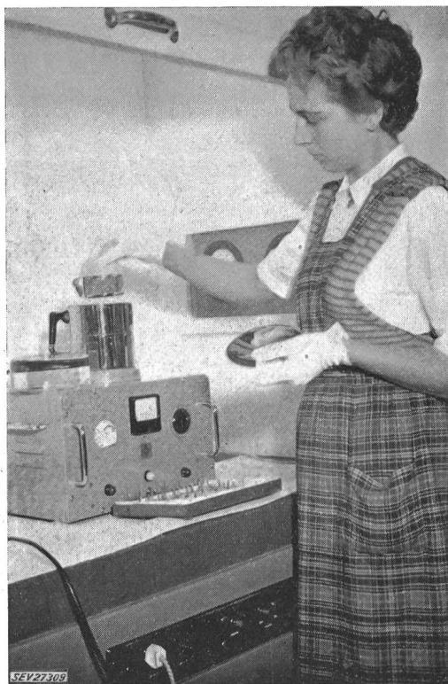
Fig. 9 Ultraschallbad zur Reinigung von Kathodenteilen
