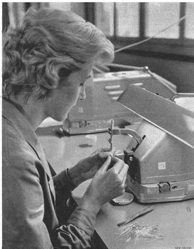
Fig. 3 Aufpunkten des Transistorelementes auf den Boden
