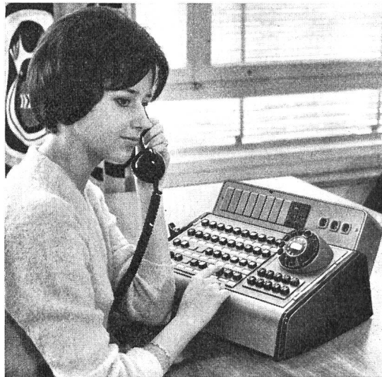
Fig. 2 «Albis»-Vermittlungsstation mit Leuchttasten und eingebautem Nummernanzeiger
