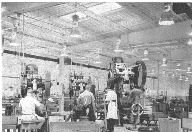
Fig. 3 Stanzerei in einer Industriehalle, beleuchtet mit Quecksilber-Halogenlampen
