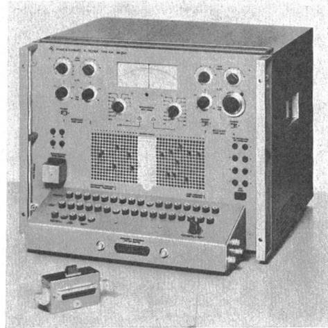
teiler. Der Gleichspannungs-Messbereich 10 mV bis 100 V ist 7fach, der Gleichstrom-Messbereich 3 nA bis 100 mA 14fach unterteilt. Der Wechselspannungs-Messbereich erstreckt sich von effektiv 10 mV bis 3 V bei Frequenzen von 10 Hz bis 1 kHz. Die Fehlergrenze der Messung liegt in allen Fällen bei  $\pm 2,5$  % vom Endausschlag.
