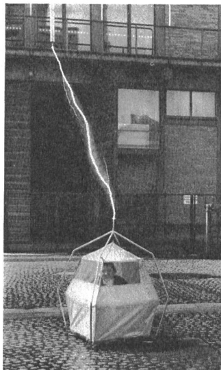
Fig. 3 Essai d'une tente de protection contre les coups de foudre exposé à la pluie et des tensions de choc de 2 millions de V
