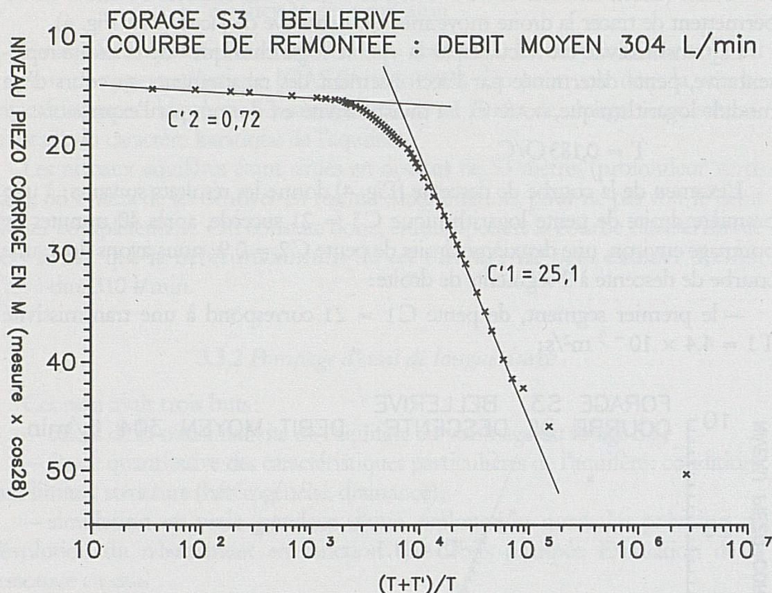
Figure 5 - Pompage d'essai de longue durée en S3 : courbe de remontée
