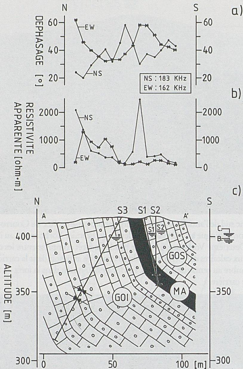
Figure 2- Profils géophysique et géologique au droit des forages S1, S2 et S3
