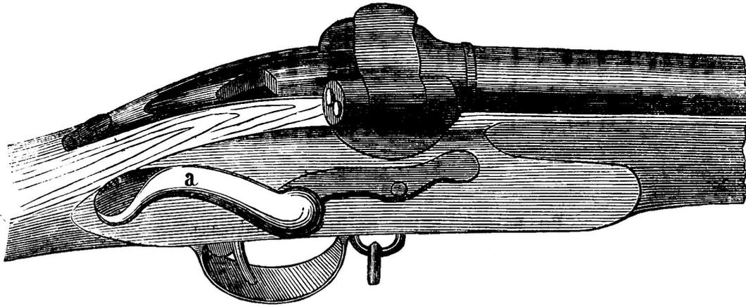
Dieses System beruht auf Einzelladung. Als Verschluss dient der Schwingblock, ähnlich wie beim englischen Snibergewehr; das Charnier, um welches sich der Block dreht, ist auf der rechten Seite des Gewehres angebracht und geschieht die Drehung folglich von links nach rechts. —
