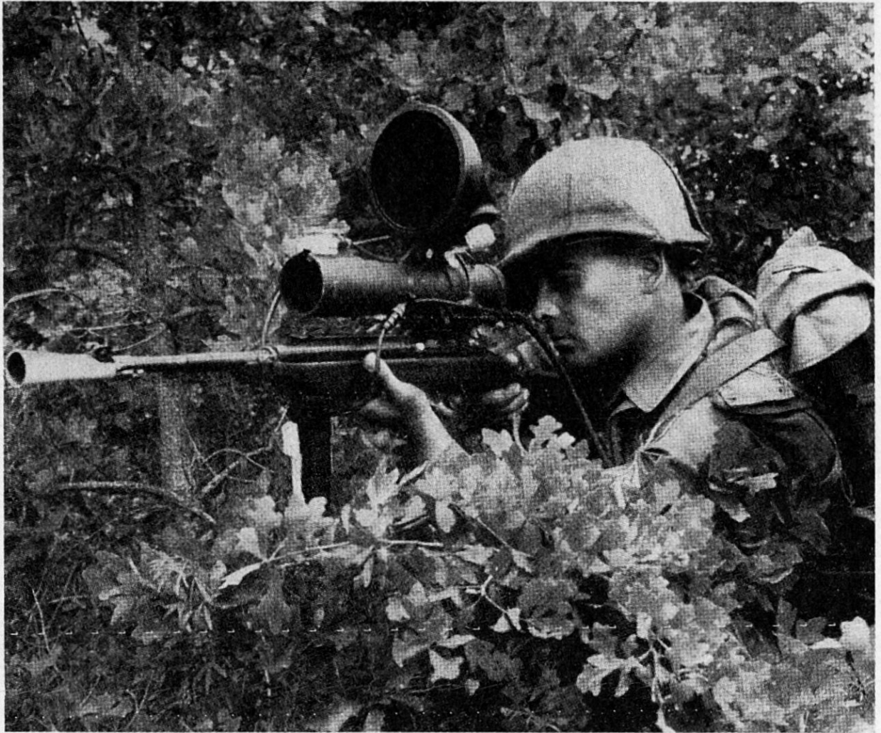
Fig. 1. Ein Infrarot-Gerät auf den direkt schießenden Infanteriewaffen erlaubt, in einem beschränkten Winkelbereich ein Ziel zu erkennen und damit zu zielen. Die Reichweite dieses neuen Gerätes ist erheblich größer als diejenige der gegenwärtig verwendeten Infrarotvisiere. Das Gerät kann auch die Verwendung von Infrarotgeräten beim Gegner feststellen, unterliegt aber selber auch diesem Nachteil. Pro Füsilierzug und Stab soll ein Gerät abgegeben werden.
