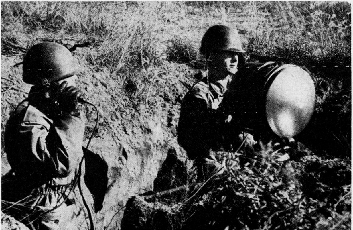
Fig. 4. Neu entwickelte Infrarotfilter für die Scheinwerfer der taktischen Fahrzeuge wie Panzer und gepanzerte Mannschaftstransportfahrzeuge in Verbindung mit einem «navigational automatic position finder», der automatisch jederzeit den Standort des Fahrzeuges in Koordinaten angibt, und zwar tags und nachts. Die Infrarotfilter in Verbindung mit den normalen Scheinwerfern werden den Gebrauch der in Fig. 1 und 3 gezeigten Geräte erleichtern, weil sie das Gelände mit infrarotem Licht überdecken, und werden das Einhalten größerer Nachtgeschwindigkeiten als bis anhin erlauben. Sobald das Fahrzeug als Infrarotquelle entdeckt ist, oder aus andern Gründen das Gerät nicht mehr verwendet werden soll, beleuchten die Scheinwerfer mit sichtbarem Licht das Gefechtsfeld.
