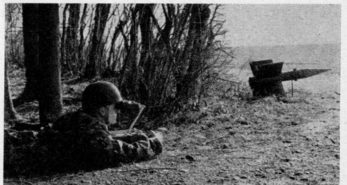
Einsatz der Lenkwaffe ab Boden, ohne Startbehälter, jedoch mit klappbarer Startstütze.
