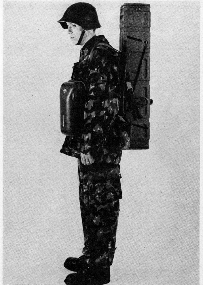
Ausrüstung des Lenkwaffenschützen mit Startbehälter und Lenkgerät.
