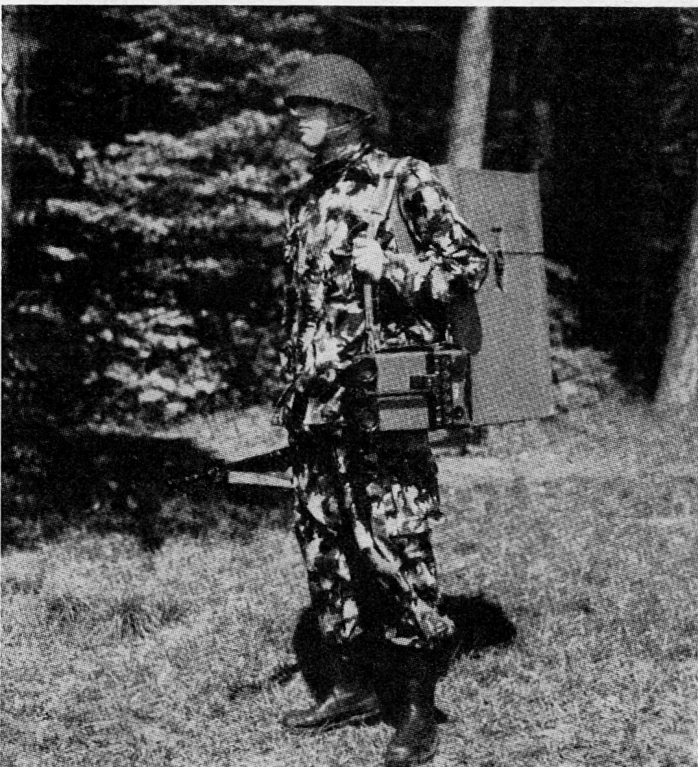
Ausrüstung des Lenkwaffenschützen mit Tragbehälter und Lenkgerät.
