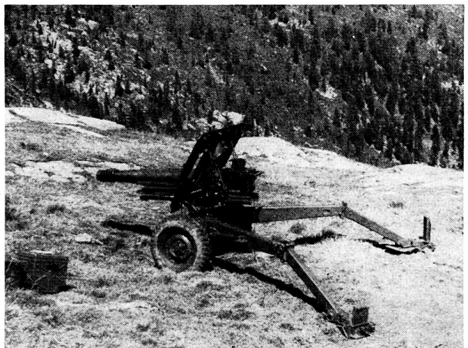
Bild 1. Die italienische Gebirgshaubitze 105/14. Gewicht 1,27 t, V_0 472 m/sec, Schußweite 10,2 km. Italienische Konstruktion, verfeuert Munition der US-IFH M-2; eingerichtet für Kraftzug, Pferdezug, Transport auf Tragtieren (12 Lasten, 116 bis 132 kg) und Mannschafts-transport. Verwendet in Gebirgs- und Luftlandverbänden. GE: leichte Gebirgshaubitze 105 mm; IT: Obice da 105/14. Photo: Archiv Stabsakademie, Wien.
