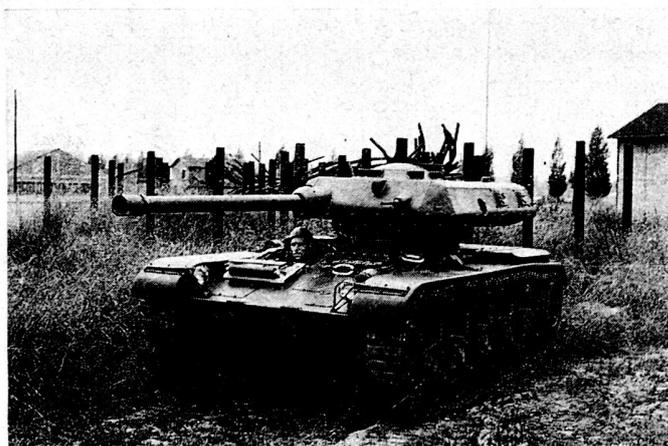
Bild 1. Kleinpanzer «Even» mit einer 90-mm-Kanone und einem Maschinengewehr.
