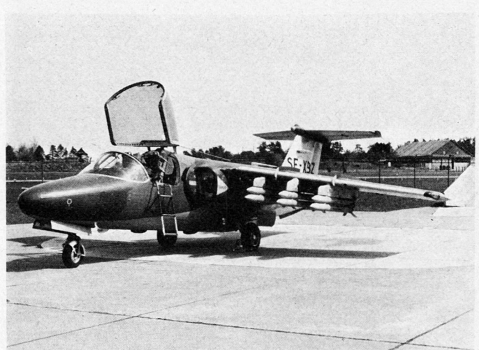
Bild 1. Saab 105 XT mit zwölf 13,5-cm-Raketen (ungelenkt), Zuladung 504 kg, Startgewicht 5,1 t, Startrollstrecke 475 m, Lo-Lo-Lo 315 km, Hi-Lo-Hi 830 km.
