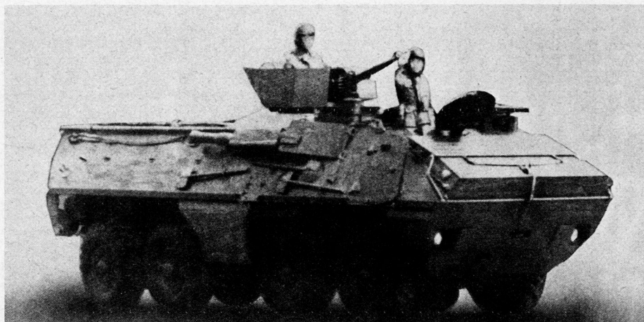
Bild 1. OT 64 mit 12,7-mm-Maschinengewehr im Drehturm.
