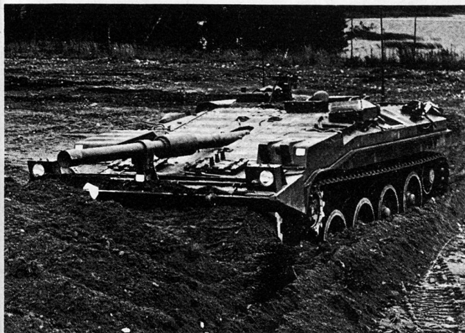
Bild 3. KPz Strv 103 mit Räumschaukel beim Eingraben.
