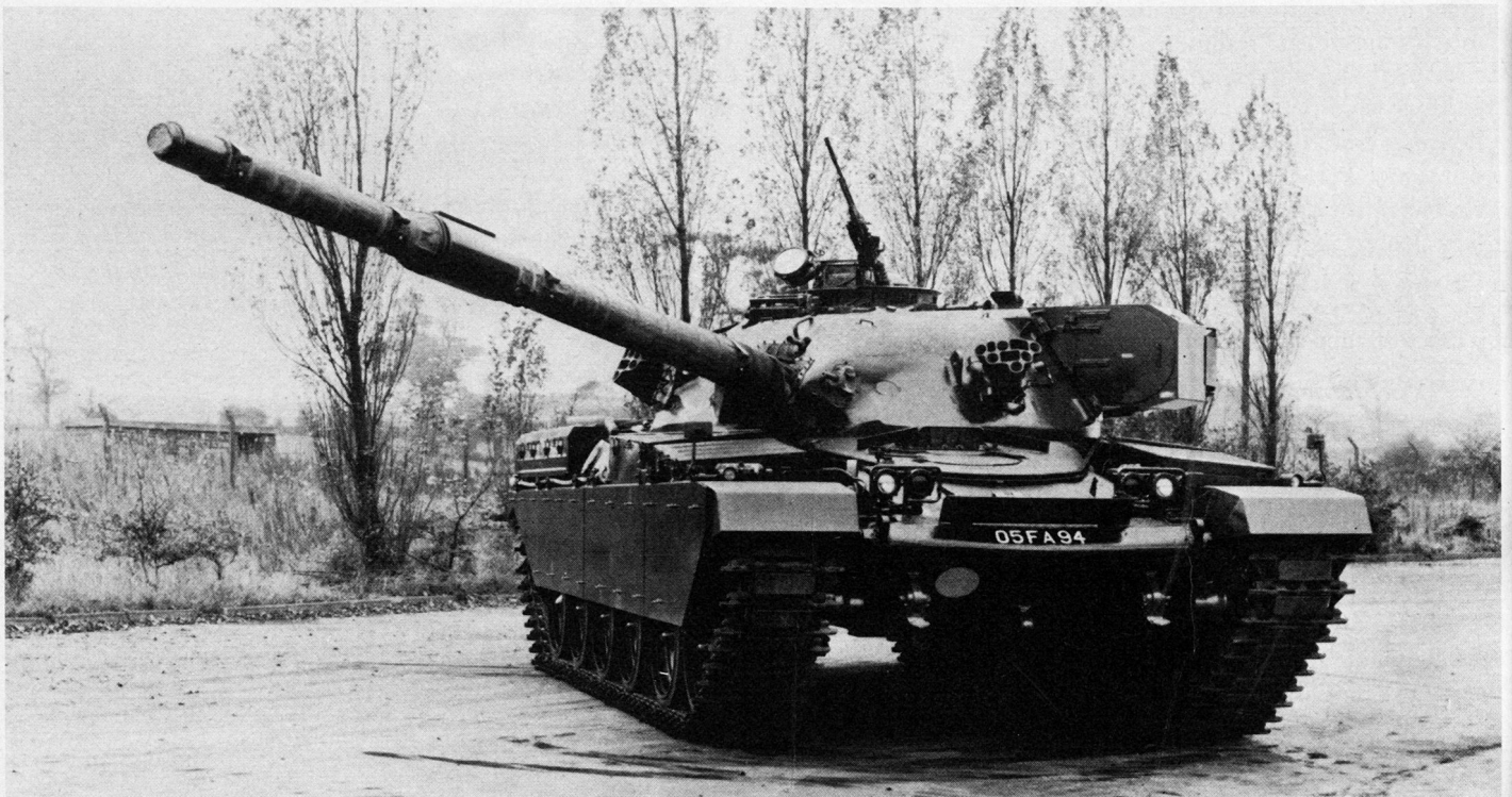
Bild 1. Englands wichtigster Panzer für die siebziger Jahre. Auf der linken Turmseite ist das gepanzerte Suchlichtgehäuse sichtbar.
