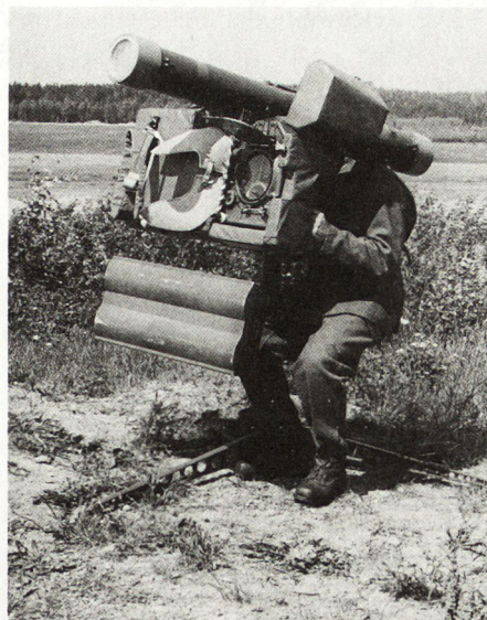
Bild 1. Die RBS 70-Feuereinheit von AB Bofors besteht aus einer Lenkwaffe im Behälter/Abschußrohr, einem Lenkgerät mit Leitstrahlender und einem Stativ, wodurch die ganze Anordnung um 360° drehbar ist. Am Stativ befindet sich auch ein Sitz für den Schützen. Die IFF-Einheit wird vom SATT entwickelt und ist unter dem Lenkgerät befestigt. Ein Zieldatenempfänger wird ebenfalls bei der Feuereinheit placiert. Ein Tonsignal im Empfänger ermöglicht dem Schützen, die Richtung zum Ziel, innerhalb von 20 km Abstand einzunehmen.
