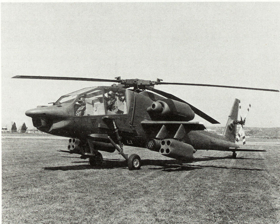
Advanced Attack Helicopter (AAH) YAH64 der Firma Hughes (USA). Mischbewaffnung aus gelenkten und un gelenkten Raketen sowie Maschinenkanonen. Forward Looking Infrared (FLIR) und Visionics Systems für Einsatz bei Tag und Nacht.
