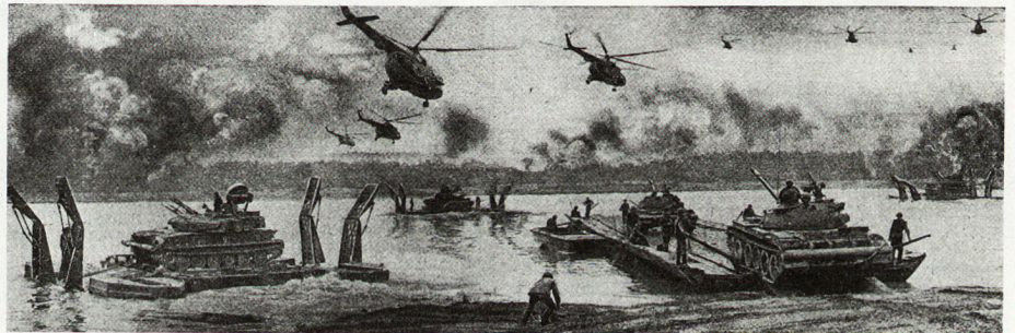
Bild 6. GSP-Fähren transportieren die ersten Panzer an das jenseitige Ufer, bevor Kriegsbrücken errichtet werden. Hubschrauber landen Motorschützen.
