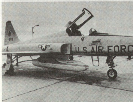
Der F-5E mit 30-mm-Kanonenbehälter von General Electric. (Siehe auch ASMZ 12/78 Seite 661: 30-mm-Kanonenbehälter KCA von Oerlikon.)
