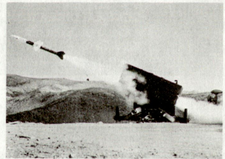
Bild 1. Lenkfläche wird vom Skyguard-Sparrow-Lenkflächenwaffenwerfer abgeschossen.
