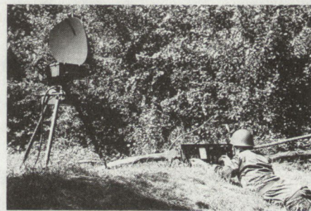
Bild 2. Rasi, Mitte der siebziger Jahre entwickelt, ist tragbar, wiegt weniger als 80 kg und verbraucht nur 130 W, leistet jedoch dasselbe wie frühere Radars.
