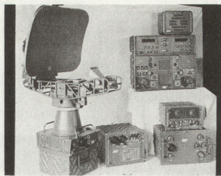
Bild 1. Ratac, um 1970 entwickelt, mit einem Gewicht von nur 160kg und einer Leistungsaufnahme von lediglich 400 W aus einer Panzer-Batterie.
