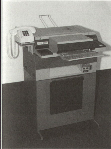
Infotec 6100. Fernkopierer der Gruppe 3 nach CCITT. Abwärtskompatibel zu allen Geräten der Gruppe 2 nach CCITT.
