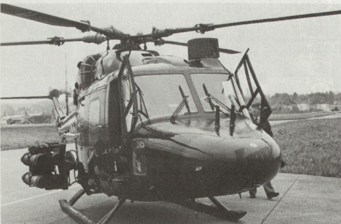
Bild 3. Multirole-Helikopter haben im Rahmen der verfügbaren Gesamtzuladung Kampffähigkeit und/oder Transportkapazität. Sie sind relativ rasch und vielfältig umrüstbar. Auf dem Bild ein Westland AH 1 Army-Lynx mit der PAL TOW (GB).
