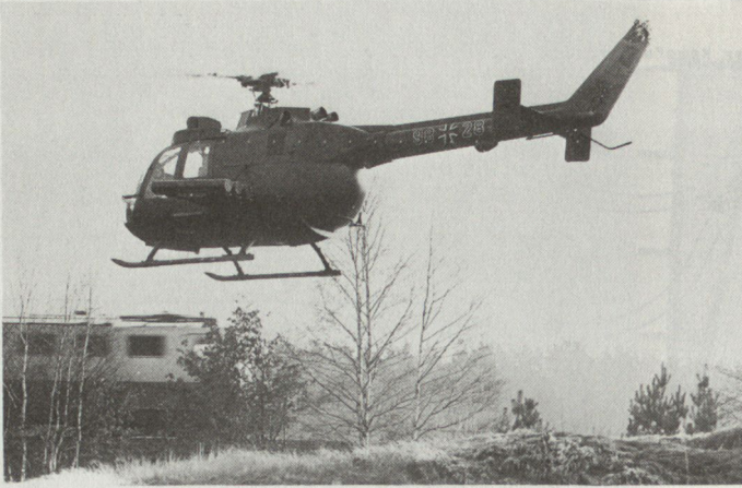
Bild 1. Einfachen Panzerabwehrhelikoptern, die ursprünglich als Verbindungs- und Beobachtungshelikopter konzipiert wurden, ist ein Luft-Boden-Panzerabwehrenkwaffensystem permanent integriert worden. Er verschiebt sich im Schleichflug und kämpft aus halbgedeckten Stellungen im feindfreien Gelände. Auf dem Bild eine MBB Bo-105 mit der PAL HOT (BRD).
