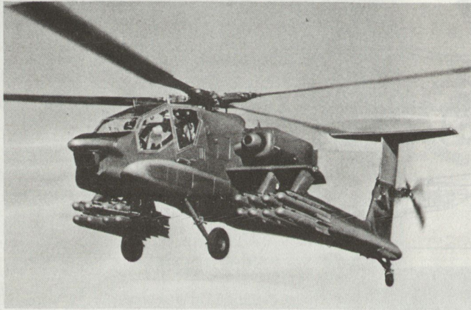
Bild 2. Kampfhelikopter sind von Grund auf für den Kampfeinsatz optimierte Waffensysteme, welche von der Bewaffnung her polyvalent einsetzbar sind. Auf dem Bild der AH-64 A Advanced Attack Helicopter «Apache» / USA mit 16 Hellfire PAL.
