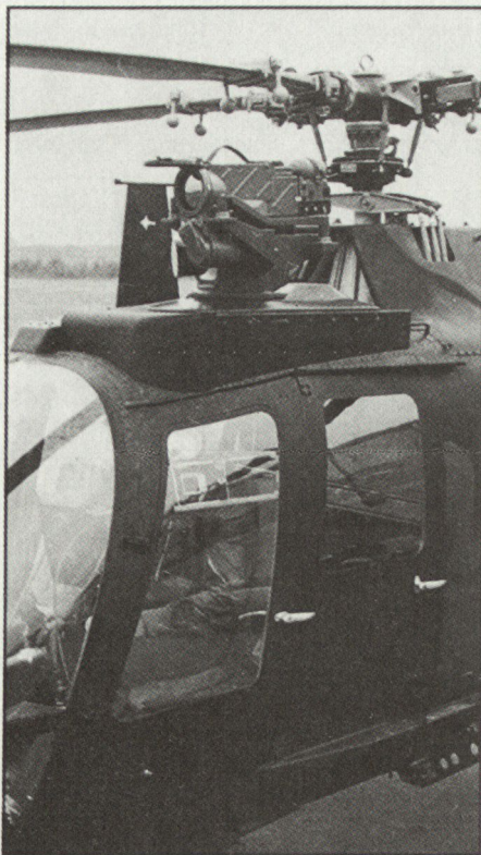
Zusätzlich zu neuen Visioniksystemen für HOT auf PAH-2 wurde im Februar 1983 eine Experimentalversion zum Nacheinsatz HOT auf Hubschraubern, wie Gazelle bzw. PAH-1, mit Erfolg im Schiessversuch getestet: 5 Schuss = 5 Treffer.
