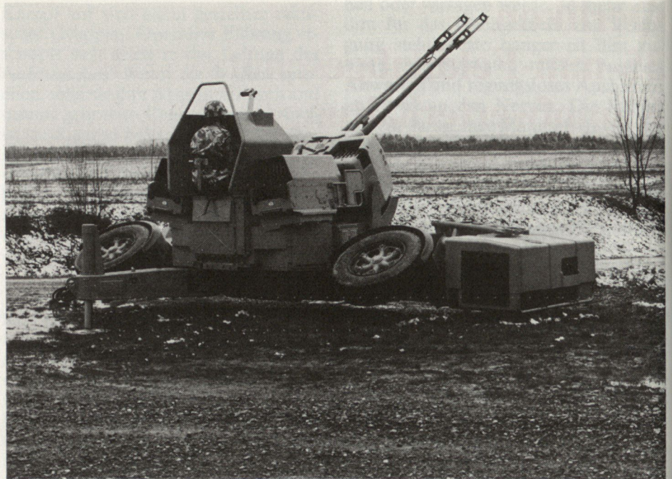
Oerlikon 35-mm-Feldflabgeschütz mit neuem 3D-Minivisier, mit Nachladeautomaten und der auf der Unterlafette integrierten Energieversorgungsanlage.
