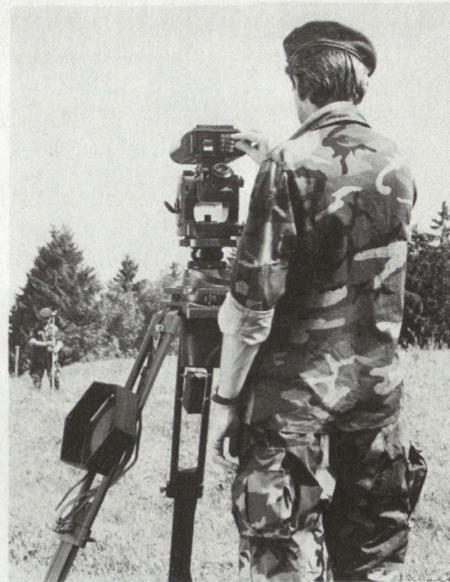
mil), Horizontal- und Vertikalwinkel ( $\pm 0.2$  mil bis  $\pm 0.05$  mil je nach Modell) sowie die Entfernung bis zu 14 km bei einer Genauigkeit von  $\pm 2$  cm innerhalb kürzester Zeit. Horizontalabstand, Höhenunterschied und Koordinatenwerte zwischen Station und Zielpunkt können vom Gerät berechnet und dadurch die Lage und Richtung der Geschütze in wenigen Minuten bestimmt werden. jst
