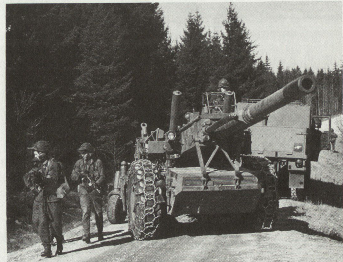
Bild 7. Gezogenes 155-mm-Geschütz mit Hilfsmotor für Stellungsbezüge.
