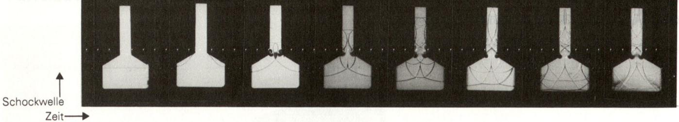
**Bild 1: Sequenz von Kurzaufnahmen (Zeitabstand rund 50 Millionstelsekunden) zum Verhalten eines Luftstosses bei einer Querschnittsverengung des Tunnels. Verwirbelungen und Reflexionen schwächen die eindringende Stosswelle.**
