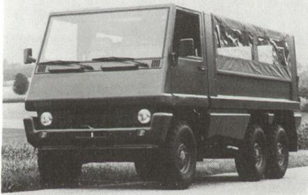
im Jahr 1985 abgelieferten zweiachsigen «Bucher-Puma 4x4» wartet die Firma nunmehr mit der **dreiachsigen Variante «Bucher-Puma 6x6»** auf, die mit **Katalysator** ausgerüstet ist.
