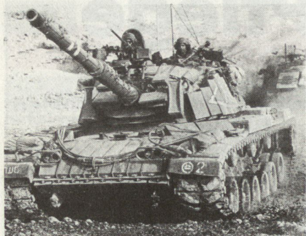
Israelischer Kampfpanzer M60 mit «Blazer-Reaktivpanzerung»
