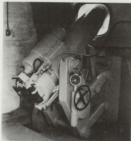
Bild 15. Geschützraum einer 15-cm-Kasemattkanone
