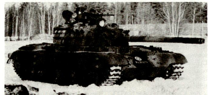
Abb. 2: Modernisierter Kampfpanzer T-55M, ausgerüstet mit Seitenschürzen, Nebelwerfern und neuer Feuerleitanlage.
