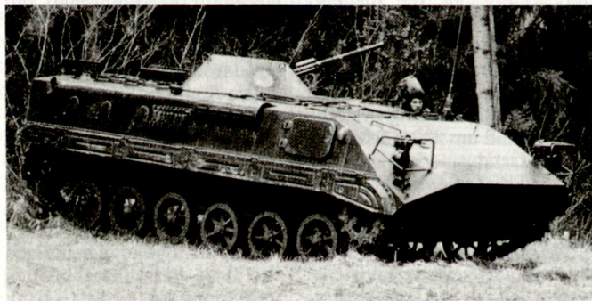
Schützenpanzer MLVM – eine vereinfachte und niedrigere Version des BMP aus eigener rumänischer Produktion.
