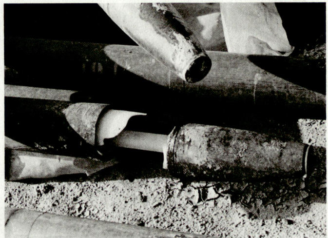
Diese Munition zum 122-mm-Mehrfachraketenwerfer ist in einem erbärmlichen Zustand. Ein Abtransport ist zu gefährlich, so dass zu ihrer Vernichtung nur eine Sprengung am Ort in Betracht kommt.
