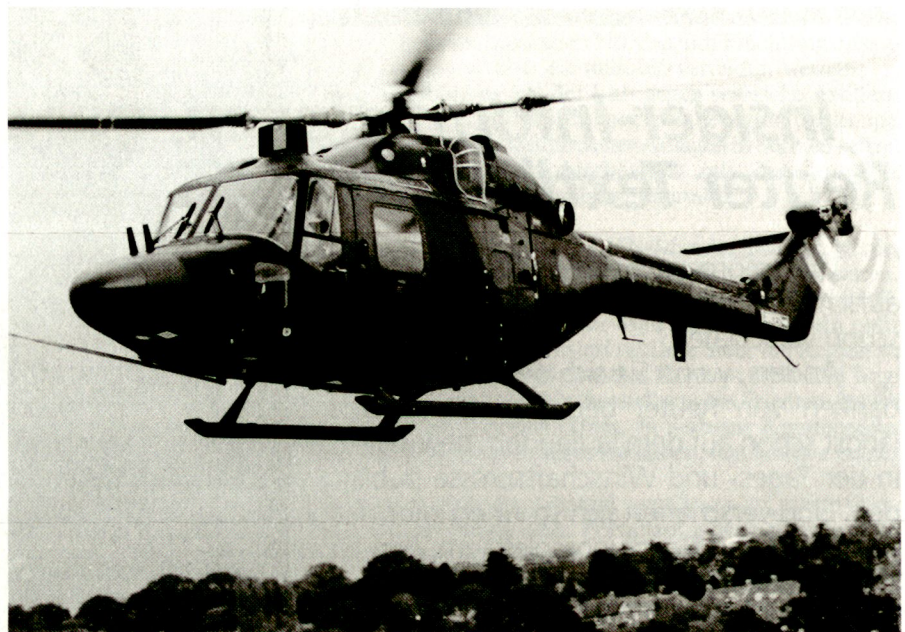
Lynx Mk7 Mehrzweckhubschrauber. Auf dem Cockpit ist die Zieloptik für den Einsatz von TOW-Panzerabwehrlenk Waffen erkennbar. Die Lenkwaffenbehälter werden hinter der Schiebetür am Rumpf montiert. Als Truppentransporter kann der Lynx 10 vollausgerüstete Soldaten mitnehmen.
