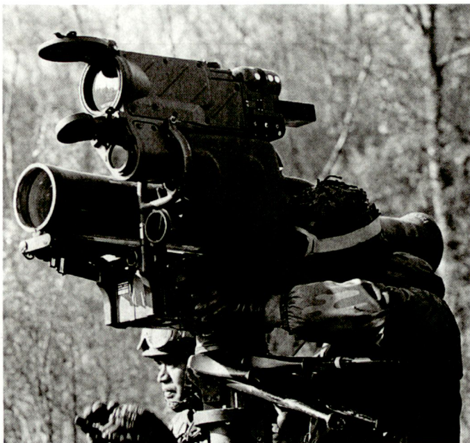
Beispiel eines Waffensystems, das in europäischer Zusammenarbeit entstanden ist: PAL-System Milan, ausgerüstet mit Wärmebildgerät Mira.
