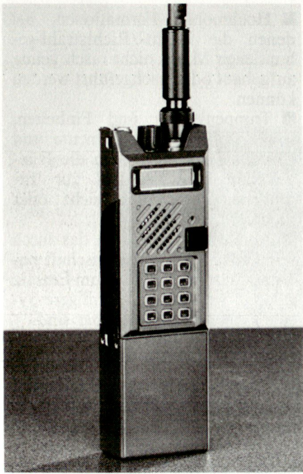
1-Watt-Handfunkgerät PR4G (Poste Radio 4 e Génération)
