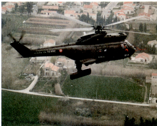
Abb. 4. Super Puma der Armée de Terre Française mit Überwachungs- und Aufklärungsradar unter dem Rumpf. Helikopter und Aufklärungssystem werden «HORIZON» genannt.
