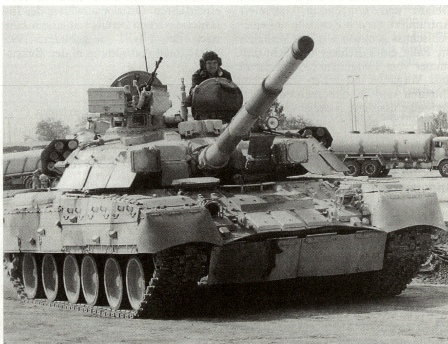
Abb. 1: Kampfpanzer T-84; eine ukrainische Weiterentwicklung des T-80UD.
