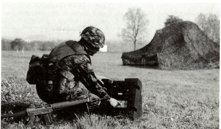
Ermitteln von Meteo-Daten mittels modernsten Geräten: Wettersoldat beim Arbeiten an der ausgebauten Bedienkonsole BEKO der Peilausrüstung P-763 für den Artillerie-Wetterdienst. (Fritz Brand, Armee fotodienst)
