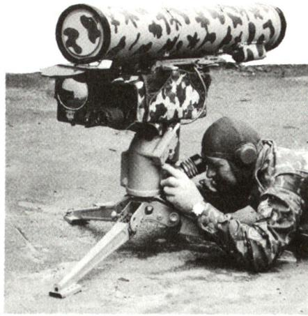
Abb. 4: Russisches PAL-System «Kornet» (AT-14), das mit einer Laser-Leitstrahlleitung (Laser Beam Rider) versehen ist.
