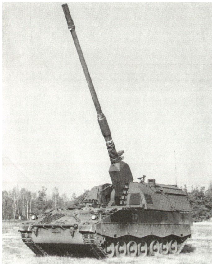
Die für die deutsche Bundeswehr vorgesehene Panzerhaubitze 155 mm PzH 2000 ist für das Verschiessen der intelligenten Munition SMART vorgesehen.
