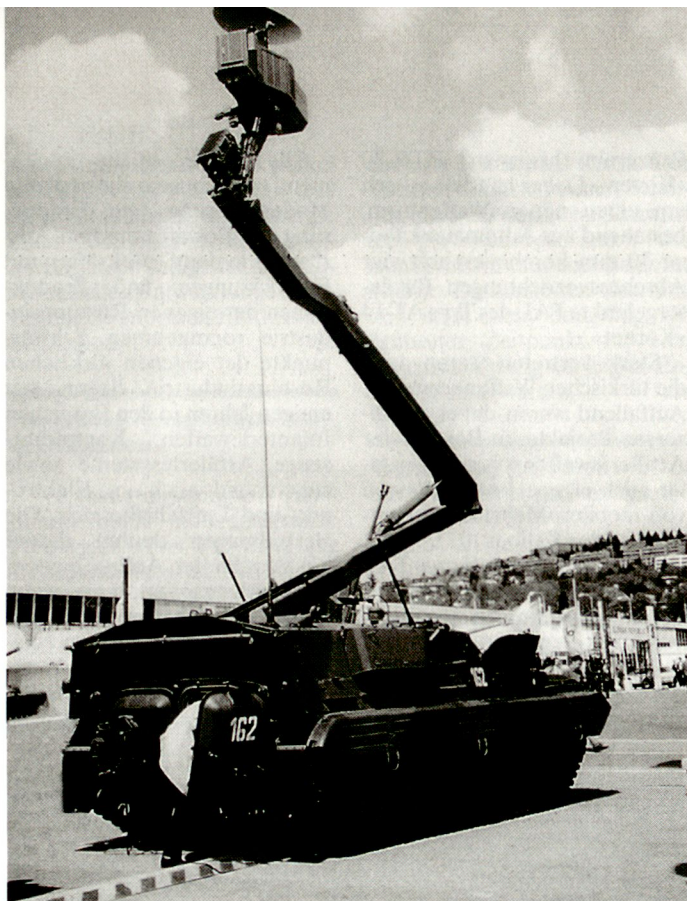
Aufklärungsschützenpanzer «Snezka» mit ausgefahrenem Teleskopmast.
