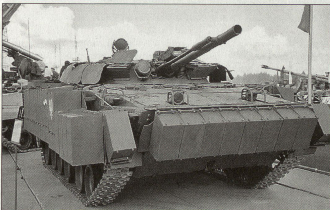
BMP-3 mit aufgebauter Reaktivpanzerung.
