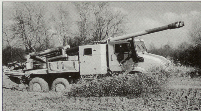
Leichtes mobiles Artilleriesystem «Caesar» vom Kaliber 155/52 mm.
