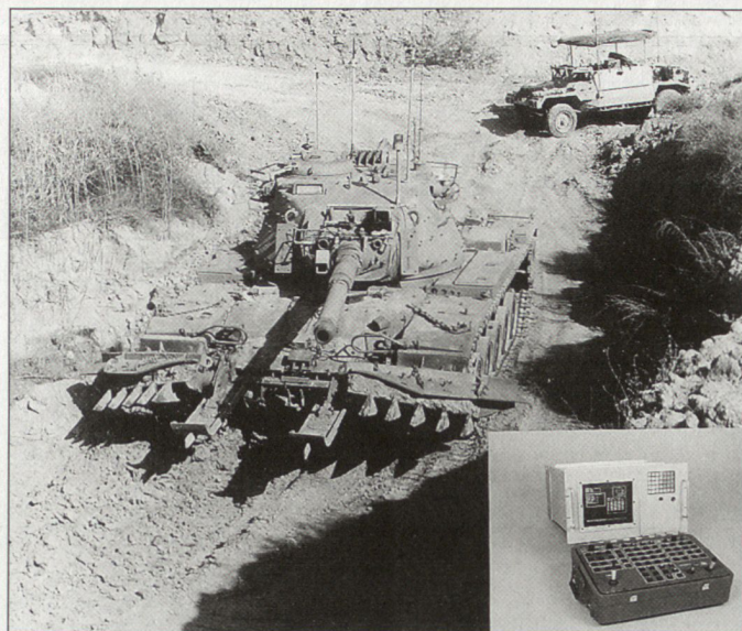
Israelisches Fernbedienungssystem für Kampffahrzeuge vom Typ Pele-2000.
